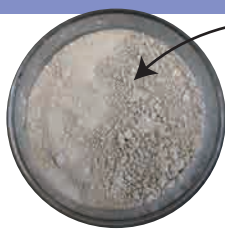
房州粉と磨き砂を混ぜた研磨剤
