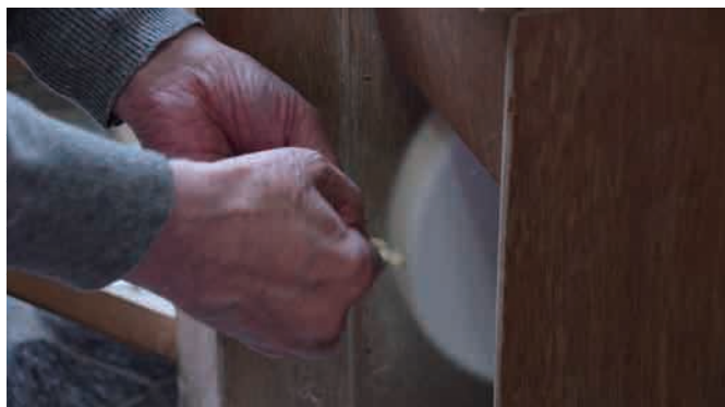
▲ 「仕上げのバフ」で磨くことで、製品に艶を出す
